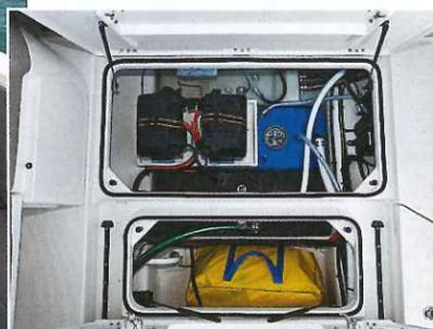
Le plancher du cockpit abrite des grands coffres dont une soute très profonde. Les capots sont assistés par de solides vérins.
