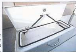
Deux vérins pour ouvrir ce coffre... QuickSilver ne mégote pas sur les détails.
