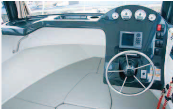
La consola de gobierno forma parte de la repisa situada bajo el parabrisas.
